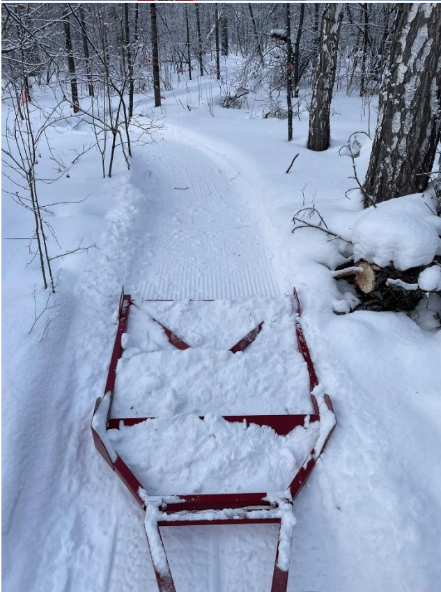
Рис. 3. Борона для прокладки быстрой лыжни БПЛ.МАК-2.ПС
