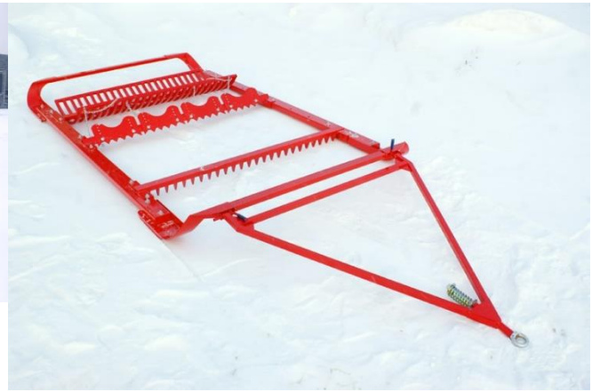
Рис. 2. Борона для подготовки скоростной лыжни (конькового хода)
