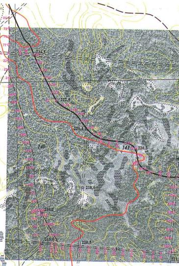
Основа для полевой съемки. На одном листе совмещены: картографическая основа, аэрофотоснимок, съемочное обоснование
