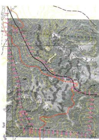
Основа для полевой съемки. На одном листе совмещены: картографическая основа, аэрофотоснимок, съемочное обоснование
